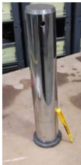
Прочный шарнирный палец крыла (длина 440 мм, диаметр 80 мм)
